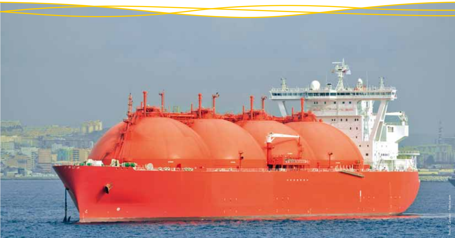
LNG Tanker mit einer Ladekapazität von 87.500 bis 154.600 m 3 gelten heute als Standardgröße. Die „Q-Max-Tanker“ aus Katar können sogar bis zu 266.000 m 3 LNG transportieren.
